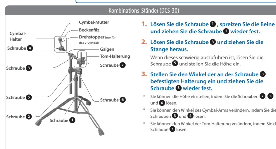
1. Lösen Sie die Schraube 1, spreizen Sie die Beine und ziehen Sie die Schraube 1 wieder fest.
