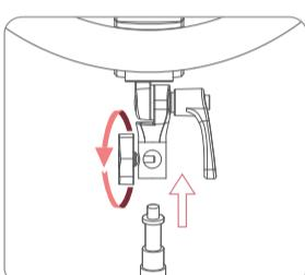
2. Montieren Sie das Ringlicht am Ständer und ziehen Sie die Ständerbefestigungs-verriegelung fest.
