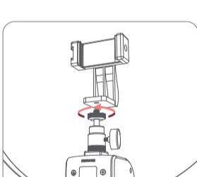
1. Achten Sie darauf, dass der Kugelkopf montiert ist.
