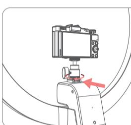
1. Montieren Sie den Kugelkopf auf den Zubehörschuh und drehen Sie dann die Zubehörschuhverriegelung, bis sie fest sitzt.
