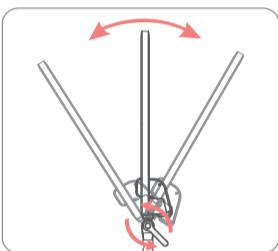
3. Lösen Sie den Kippverriegelungsgriff, indem Sie den Knopf drücken und drehen Sie ihn dann zur Winkelleinstellung gegen den Uhrzeigersinn.
