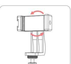
2. Lösen Sie die Klemmverriegelung, um die Telefonhalterung um 360° zu drehen.
