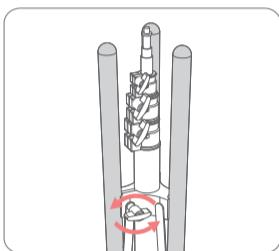
1. Lösen Sie den Schraubknopf und spreizen Sie die Stativbeine auseinander. Ziehen Sie den Schraubknopf fest, wenn der ideale Winkel erreicht ist.
