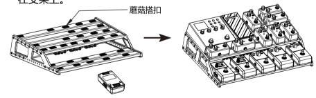
NPB-L: 320(L)x445(W)x90(H)mm (适用于10-12块单块效果器) NPB-M: 243(L)x445(W)x90(H)mm (适用于8-10块单块效果器) 注:NPB-L和NPB-M安装方式相同,NPB-M少两根上层板。
