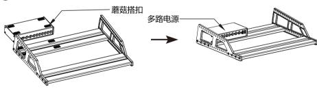
3 安装支架上层板,上层板安装完毕后拧紧全部螺丝。
