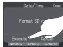
Wir empfehlen, microSD-Karten vor dem ersten Einsatz im R12 zu formatieren, um die maximale Performance zu erreichen. Bedenken Sie, dass alle auf einer microSD-Karte gespeicherten Daten beim Formatieren gelöscht werden.
