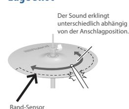
Dieses bezeichnet das Anschlagen des Rands des oberen Hi-hat-Pad mit dem Schaft des Sticks. Über den Triggereingang des Soundmoduls wird darüber der dem Bereich „Rim“ zugewiesene Sound gespielt.
