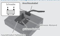
4. Befestigen Sie das dem Drum-Soundmodul beigefügte Verbindungskabel am Drum-Soundmodul (Unterseite). Drücken Sie den Stecker vollständig in die Buchse und drehen Sie dann die beiden Schrauben am Stecker fest.
