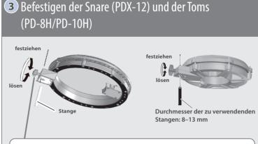
Befestigen Sie die beigefügte Flügelschraube am PDX-12, bevor Sie das Pad am Ständer montieren.
